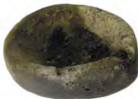
Тигель для плавки бронзы.
