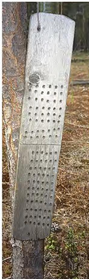
Приспособление для изготовления чопиков, используемых для определения толщины стенок лодки
