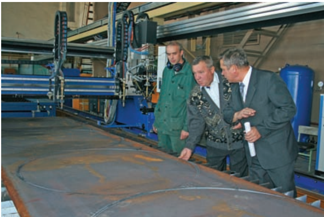
Машина по газопламенной резке металла в цехе 393
