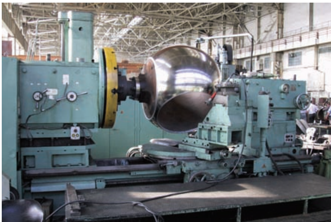
Токарный станок с пробкой шарового крана Ду 1000 мм
