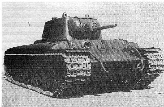
Рис. 1. Тяжелый танк КВ с пушкой Л-11 76,2 мм (1939 г.)
