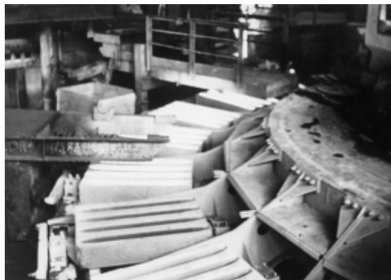
«Уралэлектромедь». Разливка меди в формы. Фото 1990-х гг.
