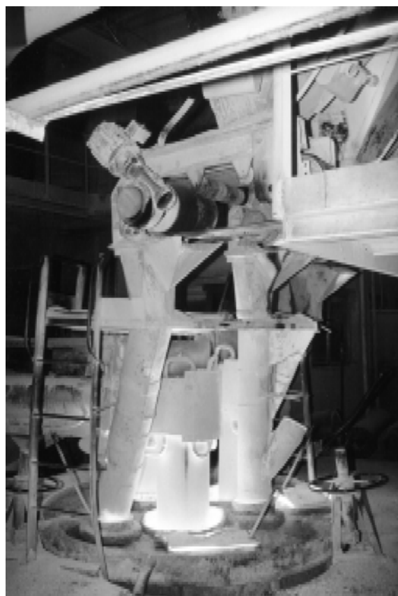
Богдановичский огнеупорный завод. Цех магнетитовых порошков. Электродуговая печь Фото 1980-х гг.
